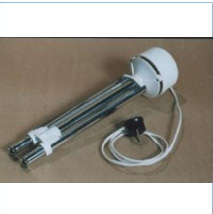
Предназначен для определения относительной влажности и температуры воздуха в наземных условиях (в помещении и на открытом воздухе). Работа психрометра основана на зависимости разностей температур сухого и «смоченного» термометра с целью последующего вычисления параметров влажности воздуха по специальным психрометрическим таблицам или графику, а температура воздуха — по показаниям сухого термометра.
