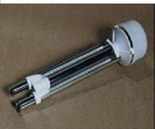
Предназначен для определения относительной влажности и температуры воздуха в наземных условиях (в помещении и на открытом воздухе). Работа психрометра основана на зависимости разностей температур сухого и «смоченного» термометра с целью последующего вычисления параметров влажности воздуха по специальным психрометрическим таблицам или графику, а температура воздуха — по показаниям сухого термометра.
